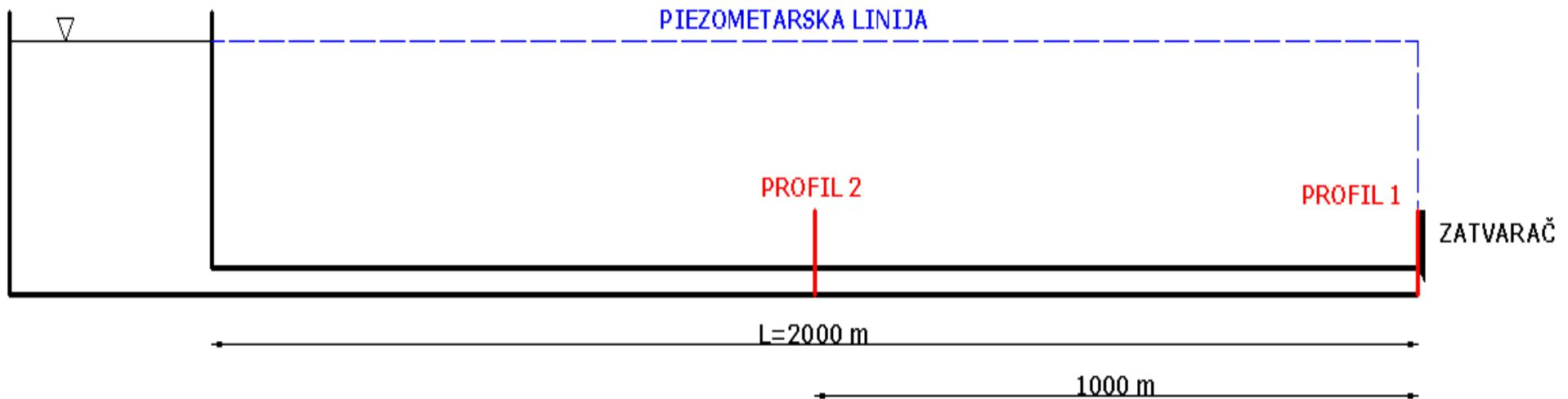
**Najprije se određuju veličine koje opisuju proces širenja poremećaja uslijed zatvaranja zatvarača na kraju cjevovoda, i to brzina širenja fronta vodnog udara duž cjevovoda.**
